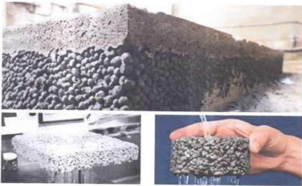
*NO FINES CONCRETE (OR) PERVIOUS CONCRETE*
